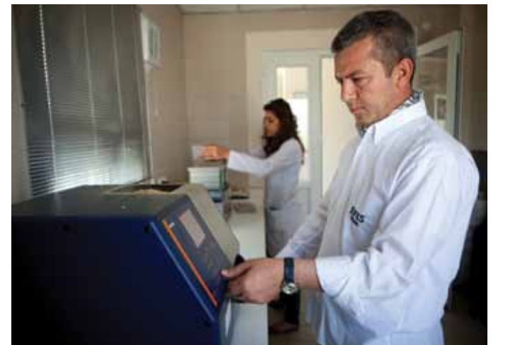
Efes, Konya'daki malt fabrikasında arpa alımlarında ileri teknoloji cihazlarla numunelerin içeriğini ölçümlüyor. Yapılan ölçümde tane iriliği, protein oranı ve rutubet içeriği tespit ediliyor.
